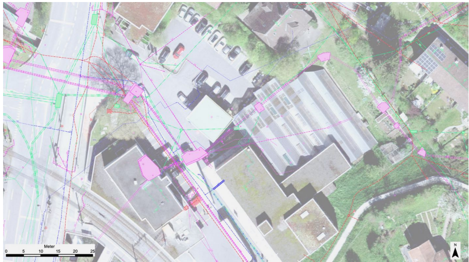
Abb. 8 Situationsplan Werkleitungen inkl. Retentionsbecken (pink)
